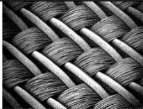
Geogewebe mit Monofil-Kette und Multifil-Schluss (Makroaufnahme 1: 10).<br>Abbildung aus Rüeegger & Hufenus (2003) |
